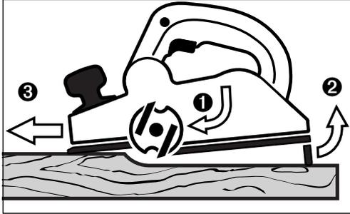
– Deslocar a pressão de apoio sobre a sola dianteira da plaina e empurrar o aparelho lentamente para frente (❶). A sapata de estacionamento **31** é virada para cima (❷), de modo que a parte posterior da sola da plaina **13** esteja novamente apoiada sobre a peça a ser trabalhada.
